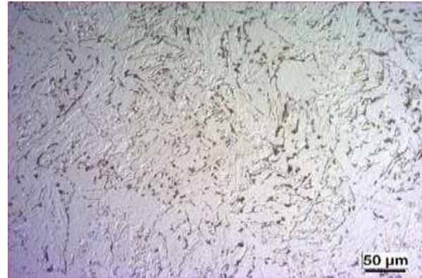
شكل (14) صورة مجهرية ضوئية لعينة معالجة بالتشكيل التقليدي (CSP)
