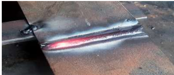
شكل (3) لحام الصفائح الفولاذية بالقوس الكهربائي
